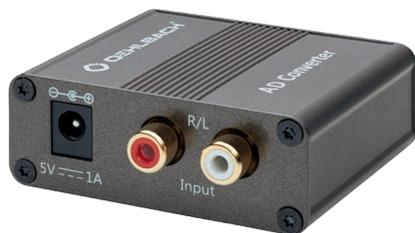
Le pont d'Oehlbach AD est utilisé pour la conversion de haute qualité d'un signal électrique analogique en un signal numérique. Après la conversion, le signal audio introduit par la RCA stéréo peut être émis soit par la sortie coaxiale numérique, soit par l'interface optique TOSLINK ; la fréquence d'échantillonnage est de 96 kHz. Des Cirrus Logic Chips précis et stables sont responsables de la conversion A/D de haute qualité.
