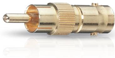
Spina di alta qualità in metallo pieno placcato oro 24 carati per l'adattamento da cinch (w) a BNC (m). Le superfici di contatto placcate in oro assicurano una bassa resistenza di contatto e garantiscono una protezione permanente contro l'ossidazione.
