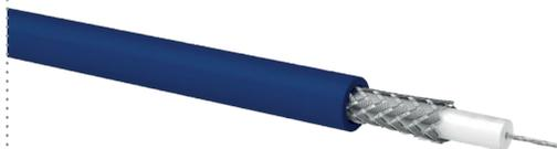
Cavo coassiale che, grazie alla sua impedenza precisa di 75 ohm, è ugualmente adatto per la trasmissione sia di dati digitali e segnali audio sia di segnali video analogici. Grazie al suo conduttore interno laminato in argento e alla schermatura laminata in argento, questo cavo garantisce proprietà conduttive eccezionali e contemporaneamente un'elevata resistenza alle interferenze.
