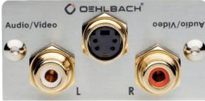
S-Video Multimedia Einsatz mit einem Lötanschluss auf der Rückseite. Der Einsatz ist mit 24 Karat vergoldeten Kontakten. In Kombination mit dem Montagerahmen können zwei beliebige Multimedia Einsätze (alternativ ein Einsatz kombiniert mit einer Blindblende) pro Rahmen mit Innenmaß 50x50mm montiert werden.
