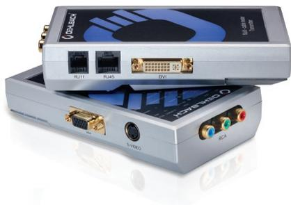
Con este multiprobador de dos partes se puede probar la continuidad eléctrica de los siguientes tipos de cables de forma rápida y segura: VGA, DVI, S-Video, Cinch, RJ11, RJ45, BNC, cable coaxial (BNC macho, F macho, antena macho). Los LEDs de control indican directamente la funcionalidad eléctrica del cable. Debido a la división en emisor y receptor, el dispositivo también es ideal para probar los cables que ya han sido colocados.
